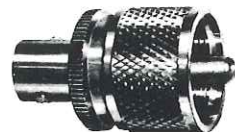
UG-273/U - Art. 4345 BNC weibl. zu PL männl. (PL-259) Raccord BNC femelle sur PL mâle (PL-259) Raccordo BNC femm. su PL masc. (PL-259)
